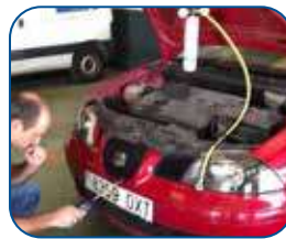
Fuga en condensador.
