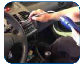
Fuga en evaporador.
